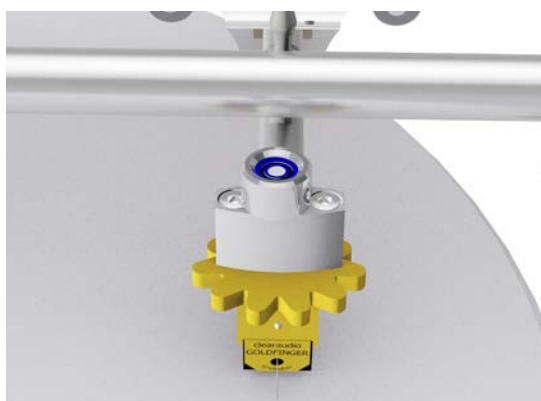
Abb. 22: Platzierung Mini Level Gauge
